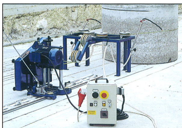
Taglio orizzontale con apparecchiatura di inversione a 90° (a richiesta).
